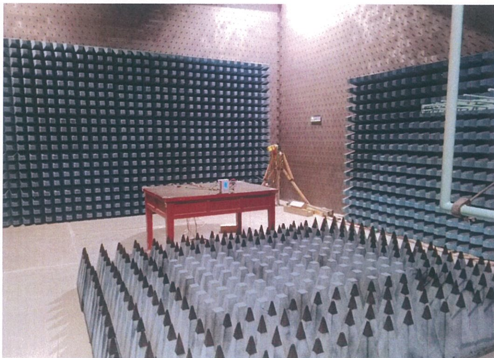
图 3: 辐射电磁场干扰检验配置图
